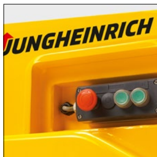
Système de boutons de recul facilitant l'accrochage et décrochage
