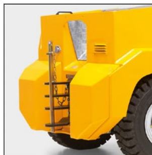
Attelage multiple pour différentes hauteurs de timon de remorque
