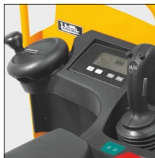
Commande de toutes les fonctions de translation et de levée à partir du levier multifonctions pour l'ESE 220/320
