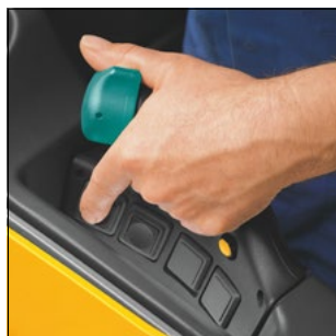
ESD 120 : Élément de commande pour la régulation de la vitesse et la fonction de levage
