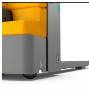
Stabilité optimale grâce aux roues stabilisatrices suspendues
