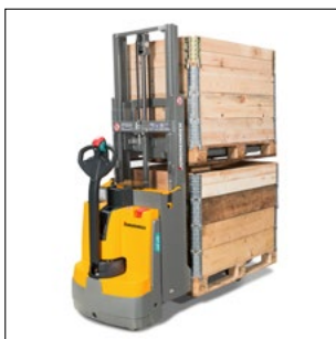
Utilisation à empiement double : prise de deux palettes superposées
