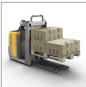
Préparation de commandes à une hauteur ergonomique grâce à la partie porte-charge élevable
