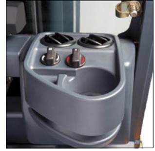
Chauffage y compris diffuseur d'air pour le pare-brise avant
