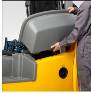
Les parties latérales peuvent être retirées facilement et sans outils
