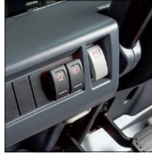
Frein de parking électrique, commande facile en appuyant sur un bouton.
