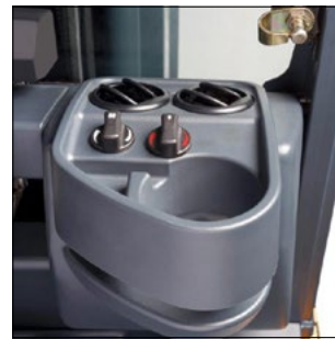
Chauffage y compris diffuseur d'air pour le pare-brise avant.
