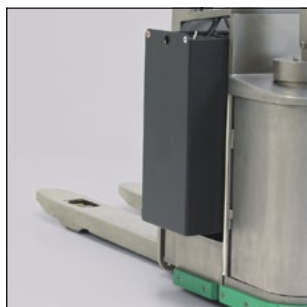
Prêt pour le changement de batterie : capot de batterie ouvert et capotage latéral amovible
